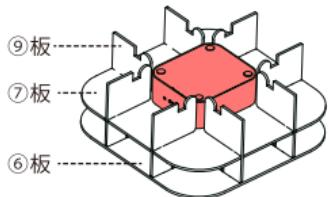
このとき⑥板の一番大きな穴から本体モーターの電源ボタンが押せない場合は⑥板の向きを変えてください。
